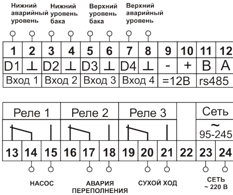
Рис. 5.7 Алгоритм 4: схема подключения
