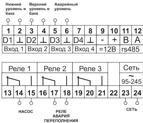
Рис. 5.5 Алгоритм 3: схема подключения
