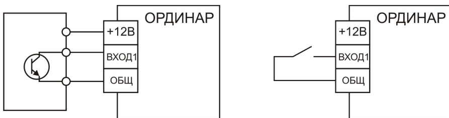
Рис. 2.2 Подключение активных и механических датчиков
